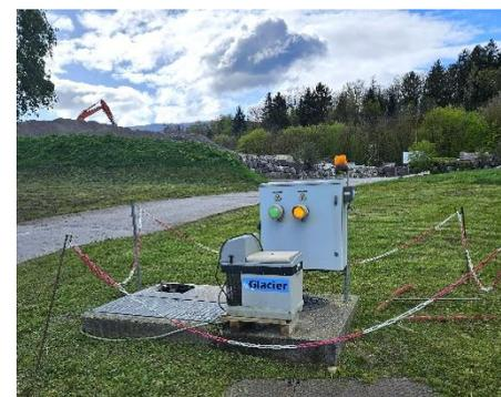
Prélèvement d'eau résiduaire en sortie de Plateforme Sud
